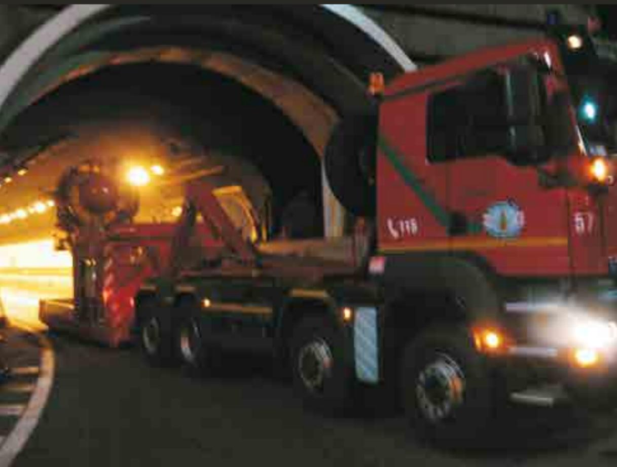
Attrezzatura speciale per la rimozione di fumi derivati da incendio in galleria, movimentabile tramite attrezzatura scarrabile – intercambiabile, con porta ruota di scorta ad azionamento idraulico posizionata dietro cabina.
