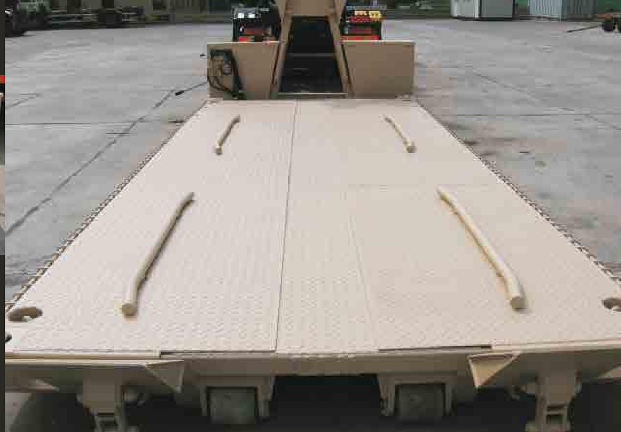
Flat-Rack per il trasporto materiale vario e carro Tank con larghezza pianale da 2500 ÷ 3000 mm e movimentazione idraulica, pedana di salita e anelli per fissaggio materiali.
