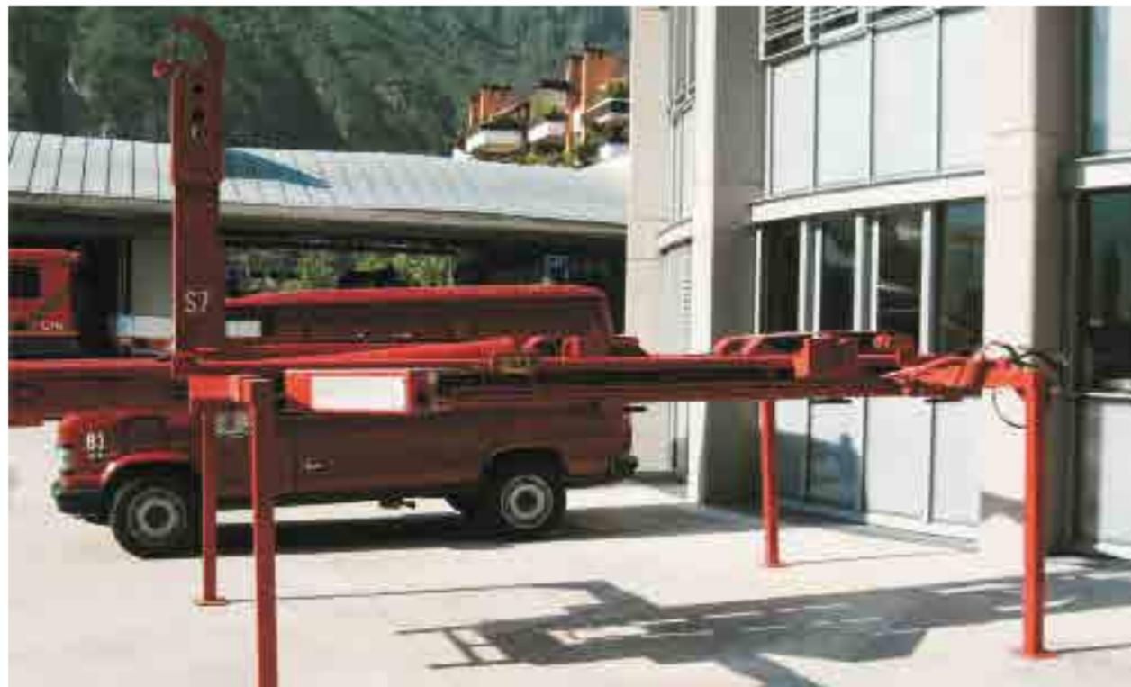
Attrezzatura scarrabile intercambiabile T20 idonea alla movimentazione di allestimenti vari in dotazione alla protezione civile ed ai vigili del fuoco. L'intercambiabilità permette la sostituzione dell'attrezzatura con altre in dotazione onde ottenere l'utilizzo con i massimi ingombri ammessi per la circolazione.
