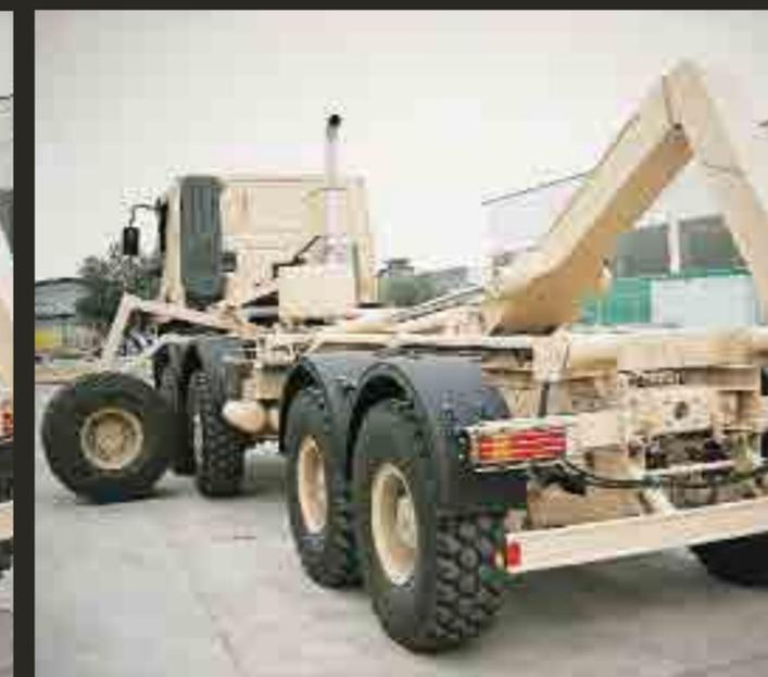
Veicolo 8x8 a ruota singola con attrezzatura T20 FT idonea al trasporto Flat-rack con porta ruota ad azionamento idraulico a mezzo impianto veicolo e con doppio pneumatico.
