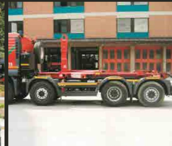
Système spécial pour enlever les fumées causées par des incendies dans les tunnels, à mouvementer par système à crochet interchangeable avec porte-roue de secours dos cabine à actionnement hydraulique.
