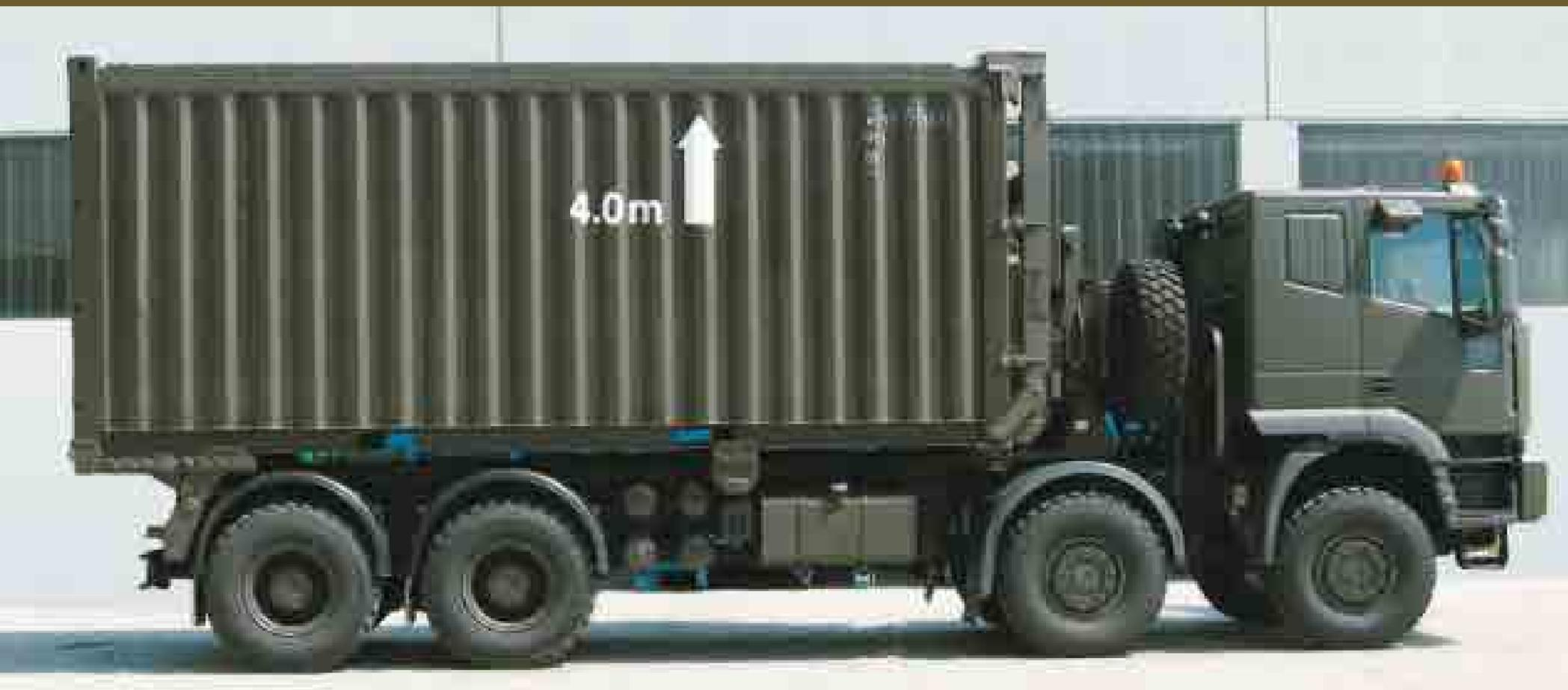
Attrezzatura T18 ISO su veicolo 8x8 tradizionale idoneo al trasporto di container ISO 1CC rimanendo nell'ingombro massimo da terra di 4 metri.
