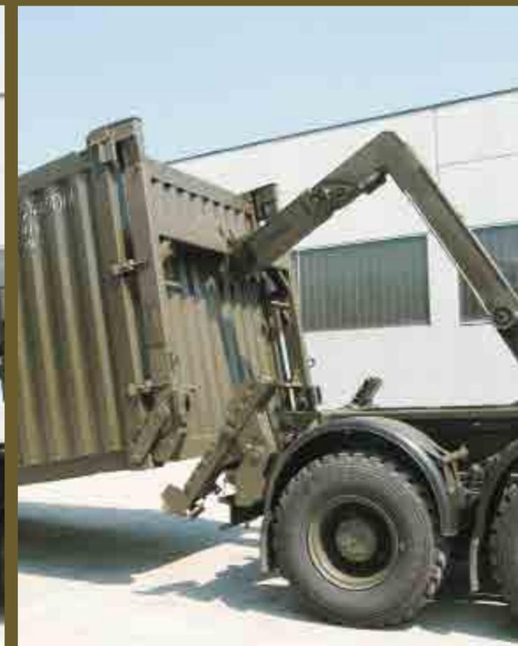
Veicolo 8x8 con attrezzatura T18 ISO con porta ruota dietro cabina ad azionamento idraulico.
