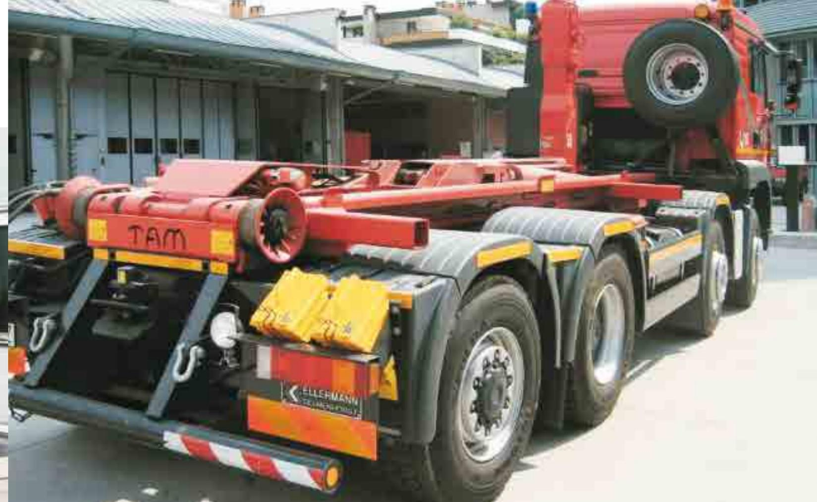
Système lève conteneurs interchangeable T20 apte à la manutention de différents équipements en dotation à la Protection Civile et aux Pompiers. L'interchangeabilité permet le remplacement du système par des autres en dotation afin d'obtenir l'utilisation avec les encombrements maxi admis par la circulation.
